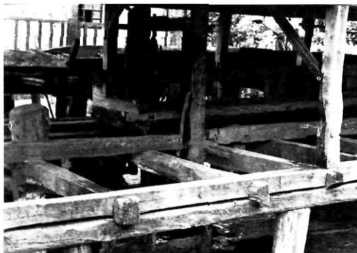
117. ábra. A fűrészkeret és a rönkkocsi
