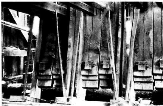
105. ábra Nyeleskalapácsok fejrésze a farokcsapokkal (Románia, Dobra Sugag, 1960.)
