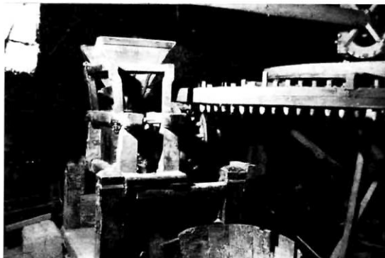
35. ábra A mekényesi szárazmalom járókereke és darálóhengere
