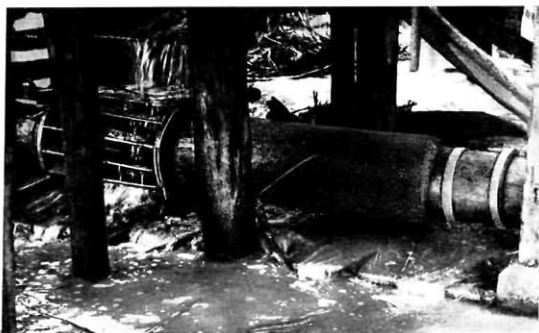
60. ábra Nagy forgásebességű tengelykerék — fűrészmalomok hajtására (Románia, Szentkeresztbánya, Vlăhija 1960.)
